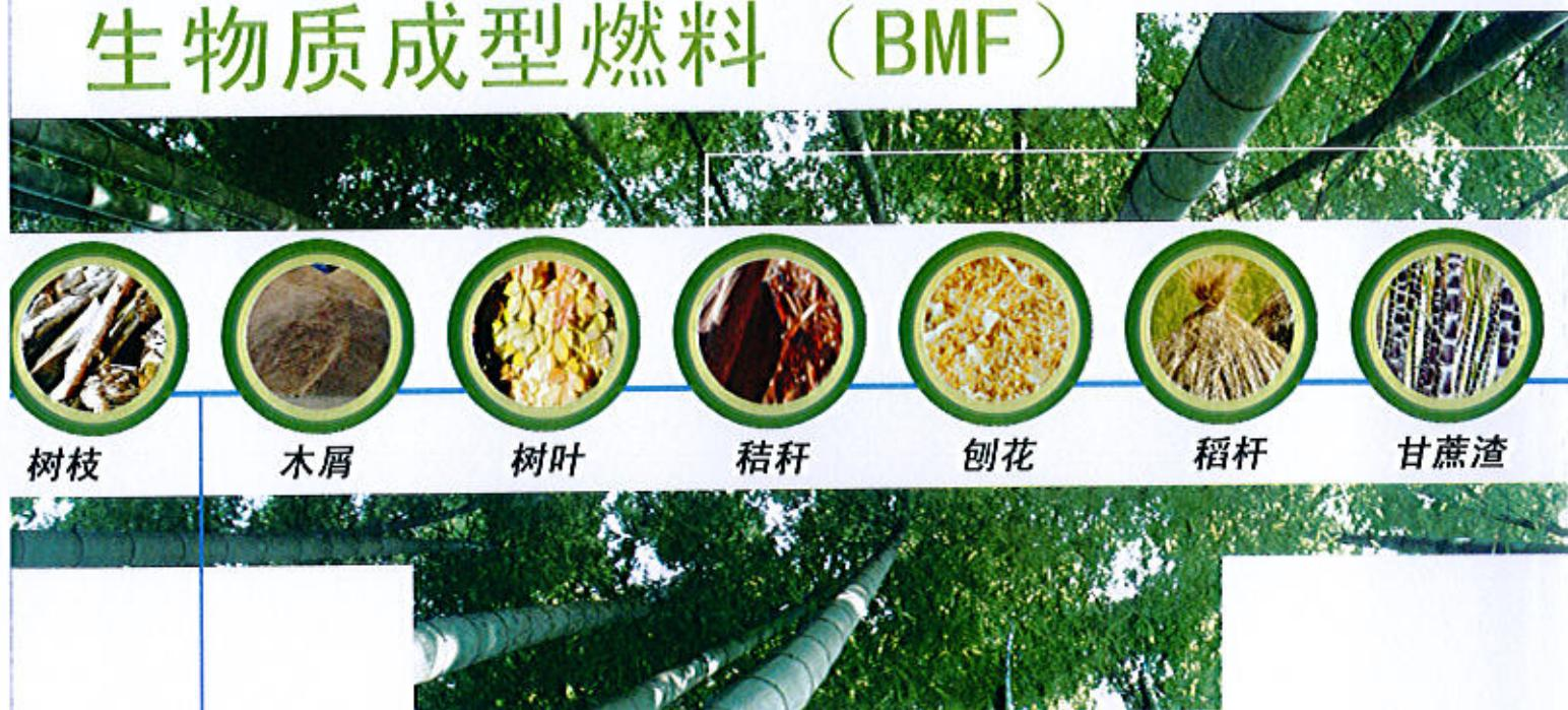
生物质成型燃料（Biomass Moulding Fuel，简称“BMF”）是应用农林废弃物（如秸秆、锯末、甘蔗渣、稻糠等）作为原料，经过粉碎、烘干、挤压等工艺，制成各种成型的（如颗粒状）可在澄宇研制的BMF锅炉内直接燃烧的新型清洁燃料。
